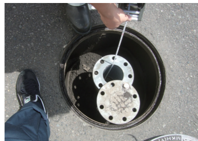
観測井の水位観測と採水調査
