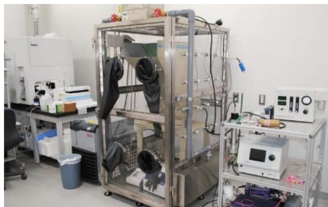
図3 ナノ材料の曝露評価システム
