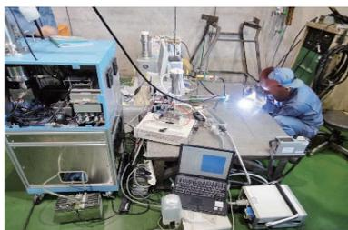
図1 溶接中の粒子状物質の計測
