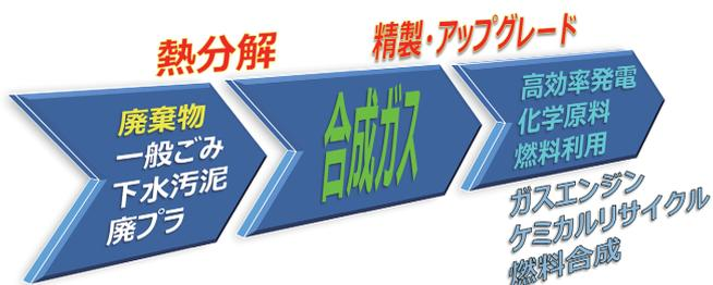
図1 熱分解によって広がる廃棄物処理の脱炭素化
