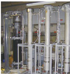
オゾン・紫外線による下水処理装置
